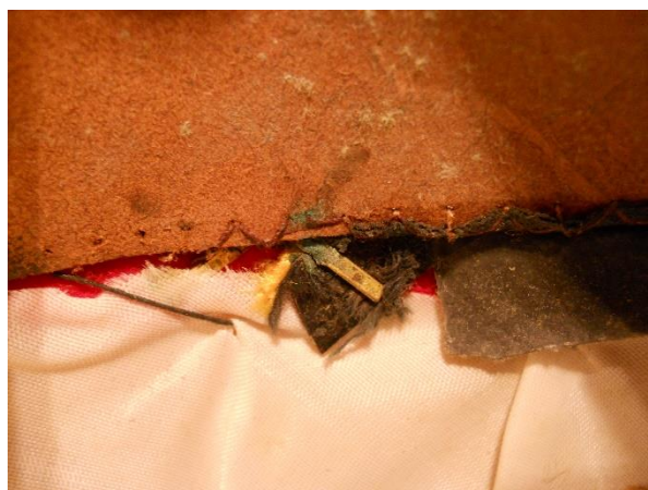
Elemento metálico de sujeción con patina de corrosión
